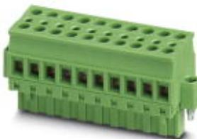
Разъемы для печатной платы, номинальный ток: 12 A, расчетное напряжение (III/2): 400 В, полюсов: 9, размер шага: 5,08 мм, тип подключения: Винтовой зажим с натяжной гильзой, цвет: зеленый, поверхность контакта: олово
