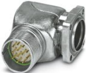
Приборный соединитель, передняя часть стенки, угловой, поворотный, экранирован.: есть, для стандартной блокировки и SPEEDCON, M23, Полясов: 12, тип контактов: Штифт, Обжим, Аксиальное уплотнительное кольцо, 4x Ø 3,2
