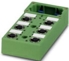
Корпус коробки датчика и исполнительного элемента, применение: Стандартн., тип подключения: Гнездовой разъем M12-SPEEDCON металл, количество гнезд: 6, полюсов: 4, механические ключи: A - стандарт, гнездо для платы: один ряд, индикатор состояния: есть, р-р-р; подключение магистрального кабеля: вставные винтовые клеммы, экранировка: нет
