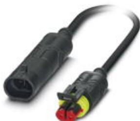
Кабель для датчика / исполнительного элемента, 2-полюсн., PUR без галогенов, темно-серый RAL 7021, Штекеры прямое Superseal Зажимное соединение, к Гнездо прямое Superseal Зажимное соединение, длина кабеля: 0,3 м
