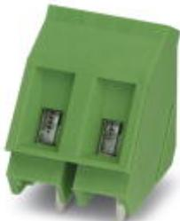
Клеммы для печатной платы, номинальный ток: 24 A, номинальное напряжение: 630 В, размер шага: 7,5 мм, полюсов: 2, тип подключения: Винтовой зажим с натяжной гильзой, монтаж: Пайка волной припоя, направление подключения, проводник/печатная плата: 55 °, цвет: зеленый. Возможна установка в ряд модулей с различным количеством полюсов (контактов)!
