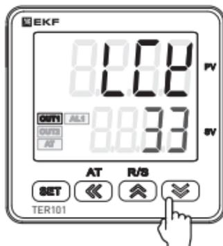
Перейдите в режим изменения параметра с помощью клавиши <=> .
