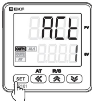
После установки нужного значения нажмите SET для сохранения значения SV параметра PV
