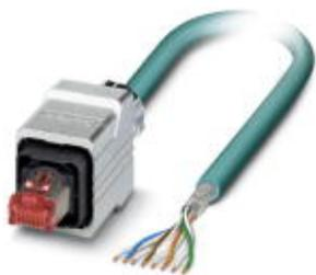
Готовый Ethernet-кабель, CAT6, экранированный, 4 пары, гибкий AWG 26 (7-проволочный), RAL 5021 (цвет морской воды), с одного конца - разъем RJ45/IP67, Push-Pull, металлический корпус, с другого - без разъема, прямая разводка, длина 5 м
