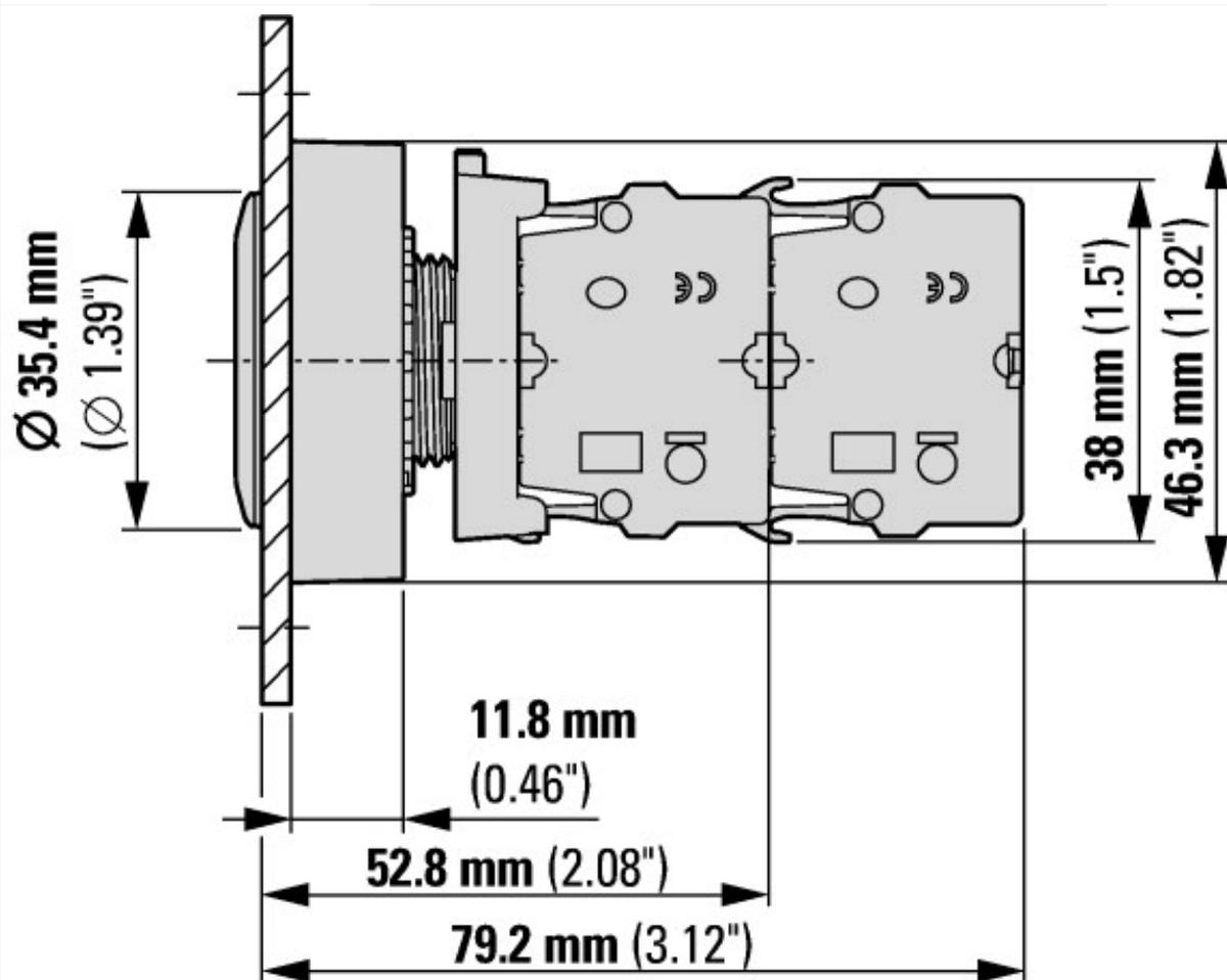
с 2 стандартными контактными элементами M22-K...
