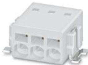
Клеммы для печатной платы, номинальный ток: 6 А, номинальное напряжение: 160 В, размер шага: 2,5 мм, полюсов: 2, тип подключения: Пружинные зажимы Push-in, монтаж: SMD пайка, направление подключения, проводник/печатная плата: 0 °, цвет: белый. Набор SAMPLE с 5 артикулами в ленточной секции. Для пайки используйте изделие без маркировки SAMPLE
