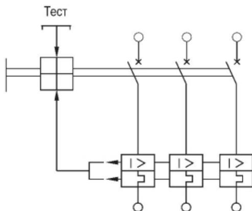
**Рисунок 7** – Электрическая принципиальная схема выключателя
