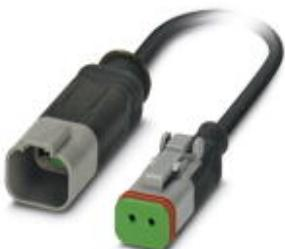
Кабель для датчика / исполнительного элемента, 2-полюсн., PUR без галогенов, темно-серый RAL 7021, Штекеры прямое DEUTSCH DT04-2P Зажимное соединение, к Гнездо прямое DEUTSCH DT06-2S Зажимное соединение, длина кабеля: 3 м
