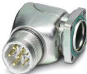
Аппаратн. соединитель, передняя стенка, угловой, поворотный, для стандартной блокировки и SPEEDCON, M23, полюсов: 4+3+PE, тип контактов: Штифт, Обжим, Аксиальное уплотнительное кольцо, 4x Ø 3,2, экранирован.: есть, размер фланца: 26 мм x 26 мм, диапазон диаметра кабеля: 0 мм ... 0 мм
