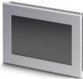
Сенсорная панель с TFT-дисплеем 17,8 см / 7"-дисплей (аналого-резистивные (полиэфир)), 800 x 480 Пиксел (WVGA), 65536 цветов, Arm9™, 200 МГц, 2x USB Host 2.0, 1x Ethernet (10/100 Мбит/с), RJ45, Windows CE 5.0 и прикладное ПО: TSvisRT. (шинная система: без)
