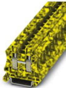
Проходные клеммы, номинальное напряжение: 1000 В, номинальный ток: 57 А, тип подключения: Винтовые зажимы, количество точек подсоединения: 2, сечение: 0,5 мм<sup>2</sup> - 16 мм<sup>2</sup>, AWG: 20 - 6, ширина: 10,2 мм, высота: 46,9 мм, цвет: черный/желтый, тип монтажа: NS 35/7,5, NS 35/15
