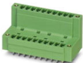
Корпусная часть для печатных плат, номинальный ток: 8 A, расчетное напряжение (III/2): 160 В, полюсов: 12, размер шага: 3,81 мм, цвет: зеленый, поверхность контакта: олово, монтаж: Пайка волной припоя, Вместе со штекерными разъемами MCV используются штекеры MCVW или MCVR.
