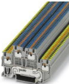
Двухъярусная заземляющая клемма, тип подключения: Зажимы Push-in, сечение: 0,14 мм<sup>2</sup> - 1,5 мм<sup>2</sup>, AWG: 26 - 14, ширина: 3,5 мм, цвет: серый, тип монтажа: NS 35/7,5, NS 35/15
