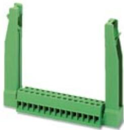
Блок для непосредственного монтажа, номинальный ток: 12 A, расчетное напряжение (III/2): 320 В, полюсов: 20, размер шага: 5,08 мм, тип подключения: Винтовой зажим с натяжной гильзой, цвет: зеленый, поверхность контакта: олово, монтаж: Непосредственный монтаж
