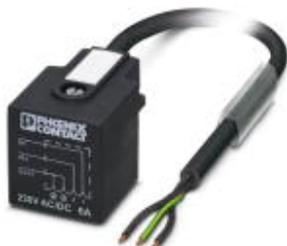
Кабель для датчика / исполнительного элемента, 3-полюсн., ПВХ, черный RAL 9005, свободный конец, к Штекер типа А для электромагнитного клапана, длина кабеля: 3 м
