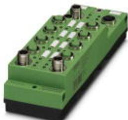
Автономное устройство для PROFIBUS имеет 8 цифровых входов, нагрузка до 2 А. Подсоединение M12 производится с использованием системы быстрого подключения. Цепь питания 24 М DC защищена от короткого замыкания и перегрузки.
