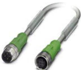
Кабель для датчика / исполнительного элемента, 4-полюсн., PUR без галогенов, стойкий к воздействию искр при сварке, повышенная гибкость, серый RAL 7001, Штекеры прямое M12, А-кодирование, к Гнездо прямое M12, А-кодирование, длина кабеля: 3 м, для использования на роботах и тяговых цепях
