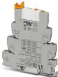
PLC-INTERFACE состоит из основной клеммы PLC-BSC.../21 с винтовым зажимом и вставным мини-реле с силовым контактом и ручным управлением, 1 переключающий контакт, входное напряжение 125 В пост. тока
