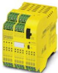
Свободно конфигурируемый модуль безопасности с 20 безопасными входами и 4 безопасными выходами; 4 сигнальных выхода, 2 выхода тактовых импульсов и 2 выхода массы; возможность выполнения диагностических операций через шлюзы шины, до SILCL 3, кат. 4/PL e, SIL 3, EN 50156, вставные клеммы с винтовыми зажимами
