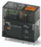
Вставное миниатюрное реле, с силовым контактом, 1 переключающих контакта, кнопка для тестирования, механический индикатор коммутационного положения, статусный светодиод, входное напряжение 230 В пер. тока
