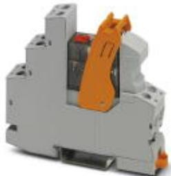
Смонтированный релейный модуль с винтовым зажимом: цоколь реле, поддерживающая скоба реле, вставной модуль подавления помех и реле с силовыми контактами с контрольной кнопкой и встроенным светодиодом состояния. Исполнение контактов: 1 переключающий. Входное напряжение: 230 В перемен. тока
