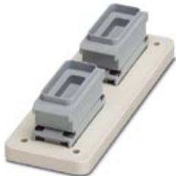
Соединительная плата, размер B24, усиленная, с монтажной рамой с защитной крышкой DSUB 9, без контактной вставки, а также монтажной рамой с защитной крышкой DSUB 9 и контактной вставкой с адаптером, гнездовая часть / гнездовая часть
