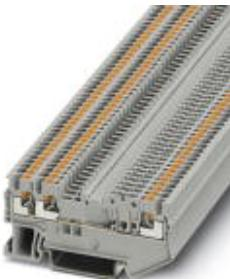
Клемма с размыкателем , номинальное напряжение: 400 В, номинальный ток: 10 А, тип подключения: Зажимы Push-in, сечение: 0,14 мм<sup>2</sup> - 1,5 мм<sup>2</sup>, AWG: 26 - 14, длина: 67,8 мм, ширина: 3,5 мм, цвет: серый, монтаж: NS 35/7,5, NS 35/15, номинальное напряжение: 400 В
