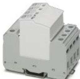
Вставной разрядник для защиты от перенапряжений, тип 2 / класс II, для 3-фазных цепей электропитания с отдельными проводниками N и PE (5-проводные системы: L1, L2, L3, N, PE). С пропускной способностью 40 кА в соответствии с требованиями VDE 0100-534:2016-10 к SPD на точке запитывания установки.
