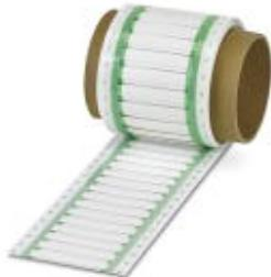
Усадочный кембрик, рулон, белый, маркируется с помощью: THERMOMARK ROLLMASTER 300/600, THERMOMARK X1.2, THERMOMARK ROLL X1, THERMOMARK ROLL 2.0, THERMOMARK ROLL: без надписи, с перфорацией, тип монтажа: надевание, диапазон диаметра кабеля: 1,6 ... 4,8 мм, размер маркировочного поля: 60 x 9 мм
