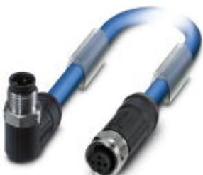
Системный кабель шины, PROFIBUS PA (31,25 кбит/с), 3-полюсн., ПВХ, синий RAL 5015, экранирован., Штекеры угловой M12, А-кодирование, к Гнездо прямое M12, А-кодирование, длина кабеля: 20 м, для использования во взрывоопасных областях с накатанной гайкой из легированной стали
