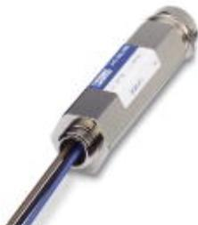
Устройство защиты от импульсных перенапряжений в форме модуля с резьбовым соединением, с корпусом IP 67, для измерительных датчиков искробезопасных цепей, наружная резьба M 20 x 1,5 для непосредственного монтажа, резьбовой сальник для сигнальных проводов, двухкаскадная схема защиты. Совместимость с HART.
