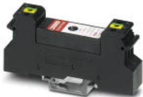
Модуль для установки на монтажную рейку, с грубой защитой от импульсных перенапряжений двух сигнальных проводников. Основание для автоматического подключения к защитному заземлению; устанавливается на NS 32 или NS 35/7.5, ширина корпуса: 17,5 мм. Исполнение: 500 В AC
