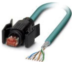
Готовый Ethernet-кабель, экранир., 4 пары, AWG 26, гибкий (7-жильный), RAL 5021 (цвет морской воды), штекер RJ45/IP67, черный, второй конец - без разъема, прямая разводка, длина 5 м
