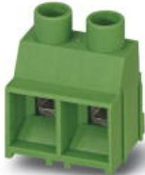
Клеммы для печатной платы, номинальный ток: 32 A, номинальное напряжение: 1000 В, размер шага: 9,52 мм, полюсов: 3, тип подключения: Винтовой зажим с натяжной гильзой, монтаж: Пайка волной припоя, направление подключения, проводник/печатная плата: 0 °, цвет: зеленый
