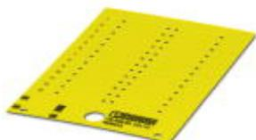
Маркировочные изделия для наклеивания, крепления с помощью винтов или заклепок, Карта, желтый, без маркировки, маркируется с помощью: BLUEMARK ID COLOR, BLUEMARK ID, THERMOMARK PRIME, THERMOMARK CARD 2.0, THERMOMARK CARD, тип монтажа: винты, заклепки, склеивание, размер маркировочного поля: 28 x 10 мм
