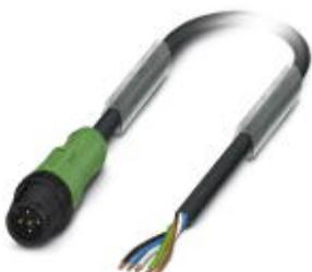
Кабель для датчика / исполнительного элемента, 5-полюсн., PUR без галогенов, темно-серый RAL 7021, Штекеры прямое M12, А-кодирование, к свободный конец, длина кабеля: 3 м, с пластмассовой накатанной гайкой
