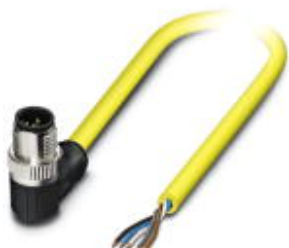
Кабель для датчика / исполнительного элемента, 5-полюсн., ПВХ, желтый, Штекеры угловой M12 SPEEDCON, A-кодирование, к свободный конец, длина кабеля: 2 м
