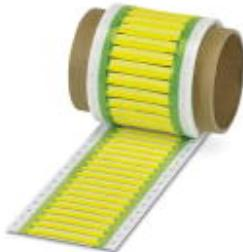
Усадочный кембрик, рулон, желтый: определяется пользователем, с перфорацией, тип монтажа: надевание, диапазон диаметра кабеля: 0,8 ... 2,4 мм, размер маркировочного поля: 15 x 4 мм
