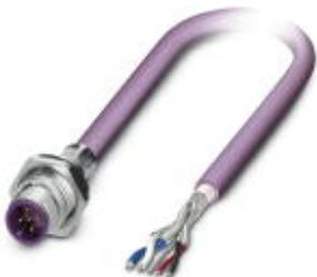
Встраиваемый разъем (вилка) шинной системы, DeviceNet/CANopen, 5-полюсный, M12, экранированный, с механическим ключом А-типа, монтаж с задней части стенки / резьбовое крепление с M16, с кабелем шины длиной 1 м, 2 x 0,2 мм<sup>2</sup>; 2 x 0,32 мм<sup>2</sup>
