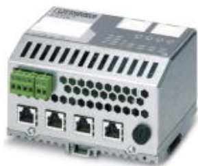
Коммутатор Ethernet, четыре порта в формате RJ45 для PROFINET RT/IRT, возможность установки на монтажную рейку
