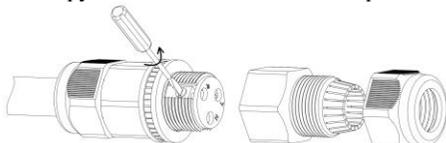
5. Продеть кабель через крышку с зажимной гайкой. Зачищенные провод вставить в отверстие на разъеме так, чтобы только оголённая часть провода оказалась внутри клеммы. Подключение проводов в разъеме производить строго в соответствии с обозначением на торцевой поверхности центральной части коннектора. Закрепить провода в клеммах закрутив винты клемм.
