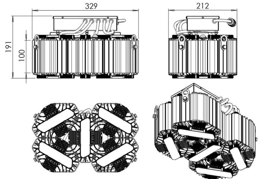
Рисунок 1 Светильник «L-lego II 250» Подвесное крепление.
