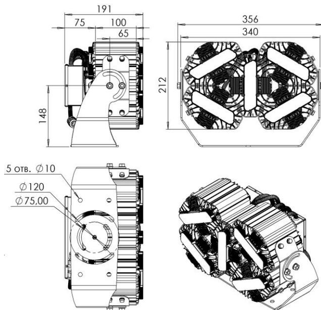
Рисунок 2 Светильник «L-lego II 250» Поворотное крепление.
