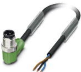
Кабель для датчика / исполнительного элемента, 3-полюсн., PUR без галогенов, темно-серый RAL 7021, Штекеры угловой M12, А-кодирование, к свободный конец, длина кабеля: 10 м
