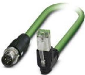
Сетевой кабель, PROFINET CAT5 (100 Мбит/с), EtherCAT® CAT5 (100 Мбит/с), 4-полюсн., ПВХ/ПВХ, зеленый RAL 6018, экранирован., Штекеры прямое M12 SPEEDCON / IP67, механические ключи: D, к Штекеры угловой RJ45 / IP20, длина кабеля: 1 м
