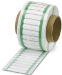
Усадочный кембрик, рулон, белый, маркируется с помощью: THERMOMARK ROLLMASTER 300/600, THERMOMARK X1.2, THERMOMARK ROLL X1, THERMOMARK ROLL 2.0, THERMOMARK ROLL: без надписи, с перфорацией, тип монтажа: надевание, диапазон диаметра кабеля: 2,4 ... 6,4 мм, размер маркировочного поля: 15 x 10 мм
