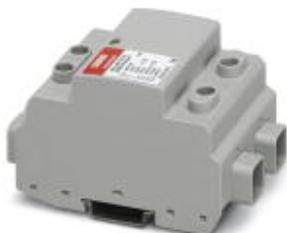
Грозозащитный разрядник / УЗИП для 2-полюсных изолированных систем пост. напряжения 600 В, монтаж на несущей рейке, варисторы с контролем температуры, индикаторы состояния на каждом модуле.
