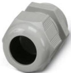
Кабельный ввод, материал резьбового соединения: PA, наружный диаметр кабеля 15 мм ... 21 мм, экранировка: нет, резьба соединительной части: M32 x 1,5, цвет: светло-серый, RAL 7035
