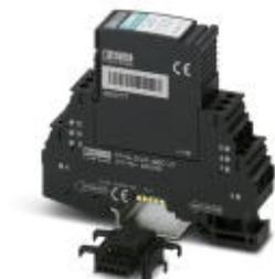
Защита от перенапряжений, включает в себя защитный штекер и базовый элемент, с встроенной многоступенчатой индикацией состояния на модуле для двух сигнальных проводников с общим опорным потенциалом. Непрямое заземление через газовый разрядник.
