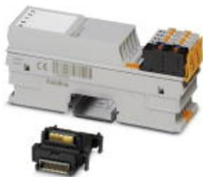
Функциональный модуль Axioline F, 1 SSI-интерфейс для датчика абсолютных значений, 1 аналоговый выход: 0-10 В, ±10 В, 0-5 В, ±5 В, 0-20 мА, 4-20 мА, ±20 мА, 2-проводн. технология соединений (с цокольным модулем и штекерными разъемами)
