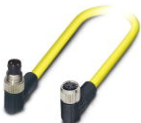
Кабель для датчика / исполнительного элемента, 3-полюсн., ПВХ, желтый, Штекеры угловой M8, к Гнездо угловой M8, длина кабеля: 1,5 м
