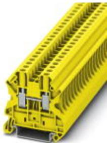
Проходные клеммы, номинальное напряжение: 1000 В, номинальный ток: 32 А, тип подключения: Винтовые зажимы, количество точек подсоединения: 2, сечение: 0,14 мм<sup>2</sup> - 6 мм<sup>2</sup>, AWG: 26 - 10, ширина: 6,2 мм, цвет: желтый, тип монтажа: NS 35/7,5, NS 35/15
