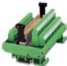
Модуль VARIOFACE для штекерного соединителя, соотв. МЭК 603/DIN 41612, исполнение F, 48-контактный, с компонентами z, b и d, с ножевыми контактами, корпус кабельного разъема с защелками
