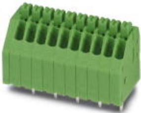
Клеммы для печатной платы, номинальный ток: 2 А, номинальное напряжение: 250 В, размер шага: 2,5 мм, полюсов: 13, тип подключения: Пружинные зажимы Push-in, монтаж: Пайка волной припоя, направление подключения, проводник/печатная плата: 45°, цвет: зеленый. Смещенные выводы под пайку, двухрядн.
